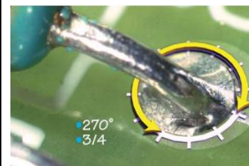
На верхней стороне печатной платы не требуется смачивание контактной площадки
